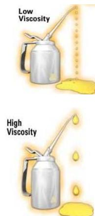
A viscosidade de um lubrificante modifica-se com a pressão e a temperatura a que este é sujeito, sendo a espessura da película lubrificante proporcional a estes fatores, ou seja, tornam-se mais "finos", quanto a temperatura sobe e mais "espessos" quando a temperatura desce.
